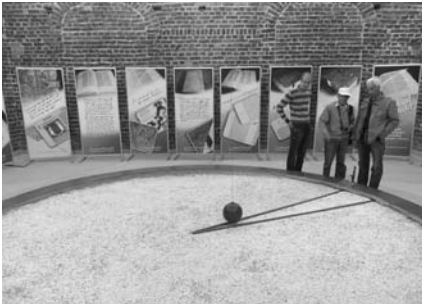
A fromborki Foucault-inga hossza 28 m, az ingalest tömege 46,5 kg
