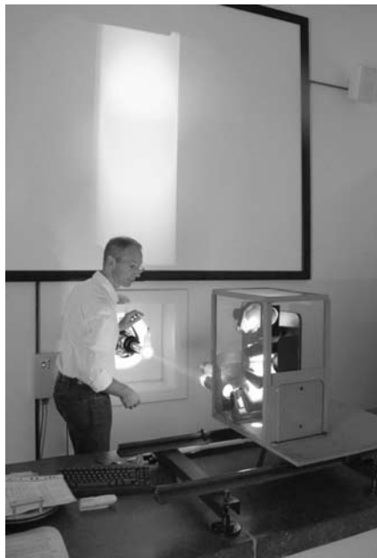
A Nap spektruma a vetítővászonon. Jól látható a falon át beérkező napfény útja, valamint a szinképet előállító prizmasor
