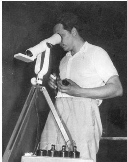
Műhold-átvonulás észlelése közben (a legendás, szovjet gyártmányú AT-1 műholdészlelő távcsővel)
