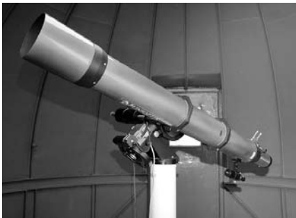
A kupolában jelenleg ezt a 150/1600-as Unioptik-refraktort használjuk. A műszert 2000-ben avattuk fel
