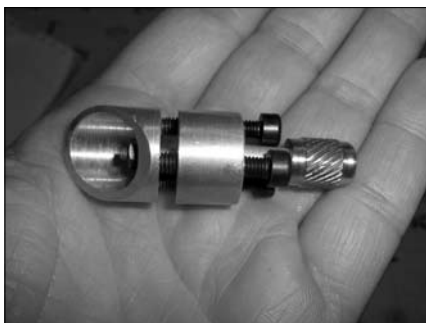
A segédtükörtartó a tenyeremben. A kis kitarakás jegyében a segédtükört FBS-sel ragasztottam fel
