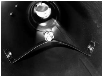
Mindent a maximális kontrasztért! A főtükörbe nem lógnak be a rögzítő karmok. A segédtükör és a tartó is alig takar ki valamit
