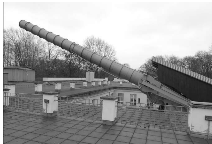
Az Archenhold Csillagvizsgáló 680/21000-as óriásrefraktora
