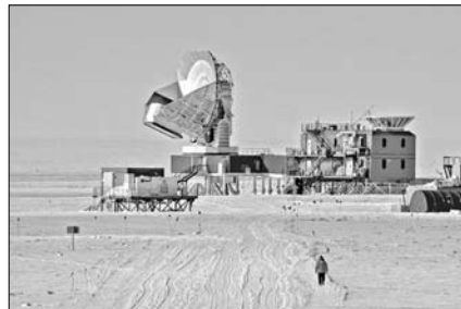
A South Pole Telescope (SPT) az antarktiszi nyárban. A jobb oldali épület tetején látható csónakkárp a BICEP-2 teleszkópot védi a környezet mikrohullámú zajától. (Stephen Hoover/University of Chicago)
