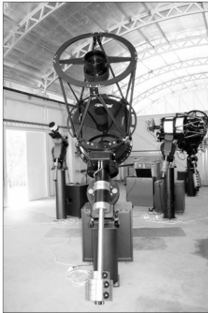
A Siding Spring-i Itelescope bázis letolható tetejű észlelőházikója belülről, előtérben a T30-as, 510/2280-as korrigált Dall-Kirkham rendszerű távcsövel
