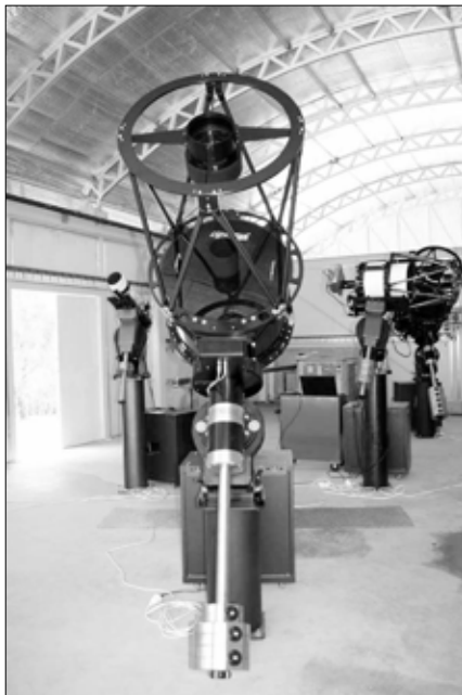
A Siding Spring-i Itelescope bázis letolható tetejű észlelőházikója belülről, előtérben a T30-as, 510/2280-as korrigált Dall-Kirkham rendszerű távcsővel
