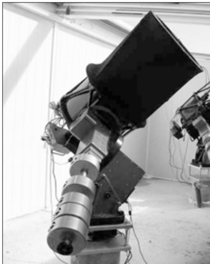
Az egyik legtöbbször „foglalkoztatott”, T7-es jelzésű, 430/2939-es, korrigált Dall-Kirkham távcső (Nerpio, Spanyolország)
