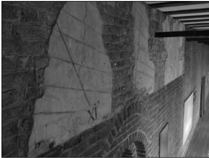
Kopernikusz olsztyni Nap-táblázatának maradványa. A Nap képét tükör vetítette a falra
