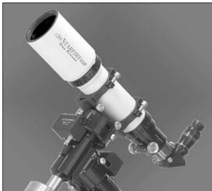
Az AstroPhysics 130/819-es EDF apokromatikus „Gran Turismo” refraktora kisebb vagonba kerül, ám szinte minden észlelési célra kitűnően teljesít
