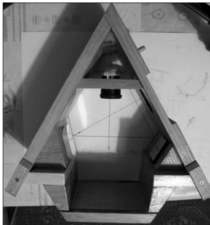
A naptávcső szerkezete
