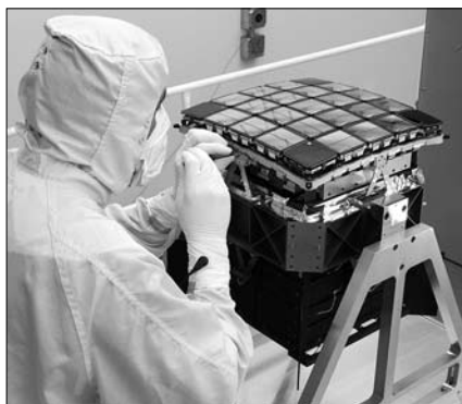
A Kepler „szeme”: a 42 db CCD-chip mintegy 95 millió pixelt tartalmaz
