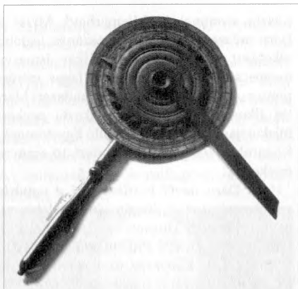
A reneszánsz új típusú időmérője, a nocturlabium, az éjszakai időmeghatározásra, XVIII. sz. (Országos Műszaki Múzeum)
