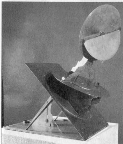
Dorn mester Regiomontanus típusú torkvétuma (1490). Valószínűleg ilyen műszert készített Mátyás király számára is (Krakkó, Collegium Maius)
