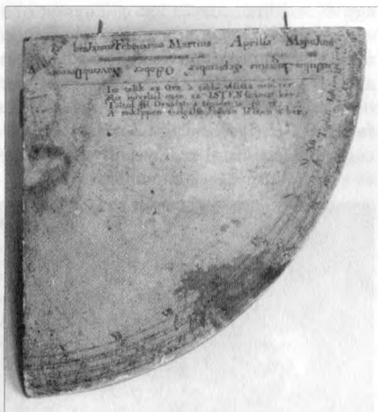
Napórának használható kézi kvadráns. Debreceni „amatőr műszerész” gyártmánya 1778-ból (Magyar Nemzeti Múzeum)
