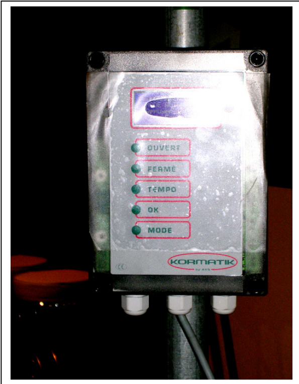
1. kép: Tejelő tehén nyakrögzítőjének irányító panelje (jelzőfények: nyitva, zárva, időtartam, működés alatt, üzemmód) (SIMAGENA, 2007, Paris-Nord-Villepinte)
