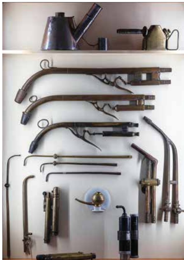
Archaikus égők, forrasztó- és olvasztópisztolyok. Lent középen: a pórispersely (bóraxadagoló) | Archaic burners, soldering and melting torches. Bottom middle: borax feeder Fotó: Varga Gábor György
