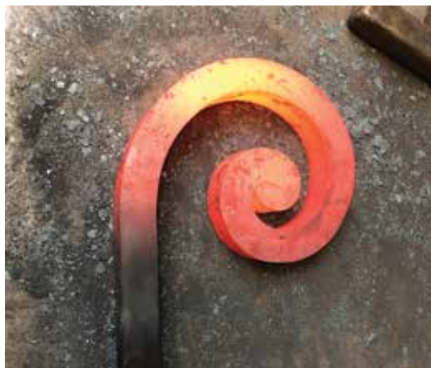
LEHOCZKY János – LEHOCZKY Tivadar: A pápai Esterházy-kastély kapuja, rekonstrukció (részlet) – munkaközi állapot. Kivitelezés: Lehoczky-műhely János LEHOCZKY – Tivadar LEHOCZKY: The gate of the Esterházy mansion in Pápa, reconstruction (detail) – interim stage. Manufacturer: Lehoczky Workshop Fotó: Lehoczky Tivadar
