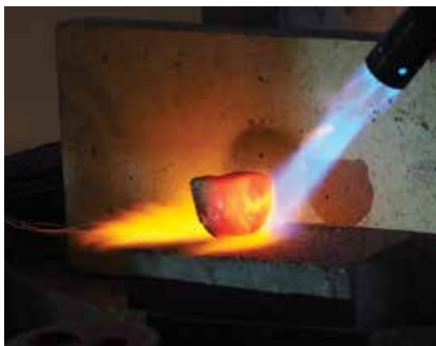
Ezüstolvasztás saját készítésű tégelyben (VARGA Gábor János „találmánya”), 2019 Melting silver in self-made crucible (Gábor János VARGA's 'invention'), 2019 Fotó: Lenzsér-Mezsei Kata
