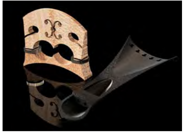
BÁN Miklós: Viola da fusione (részlet). Szabályozható magasságú és dőlésszögű híd és a húrtartó a boventartó konzol oldalán Miklós BÁN: Viola da fusione (detail). Bridge of adjustable height and angle of inclination, as well as the tailpiece on the side of the tailgut holder 2020, digitális render
