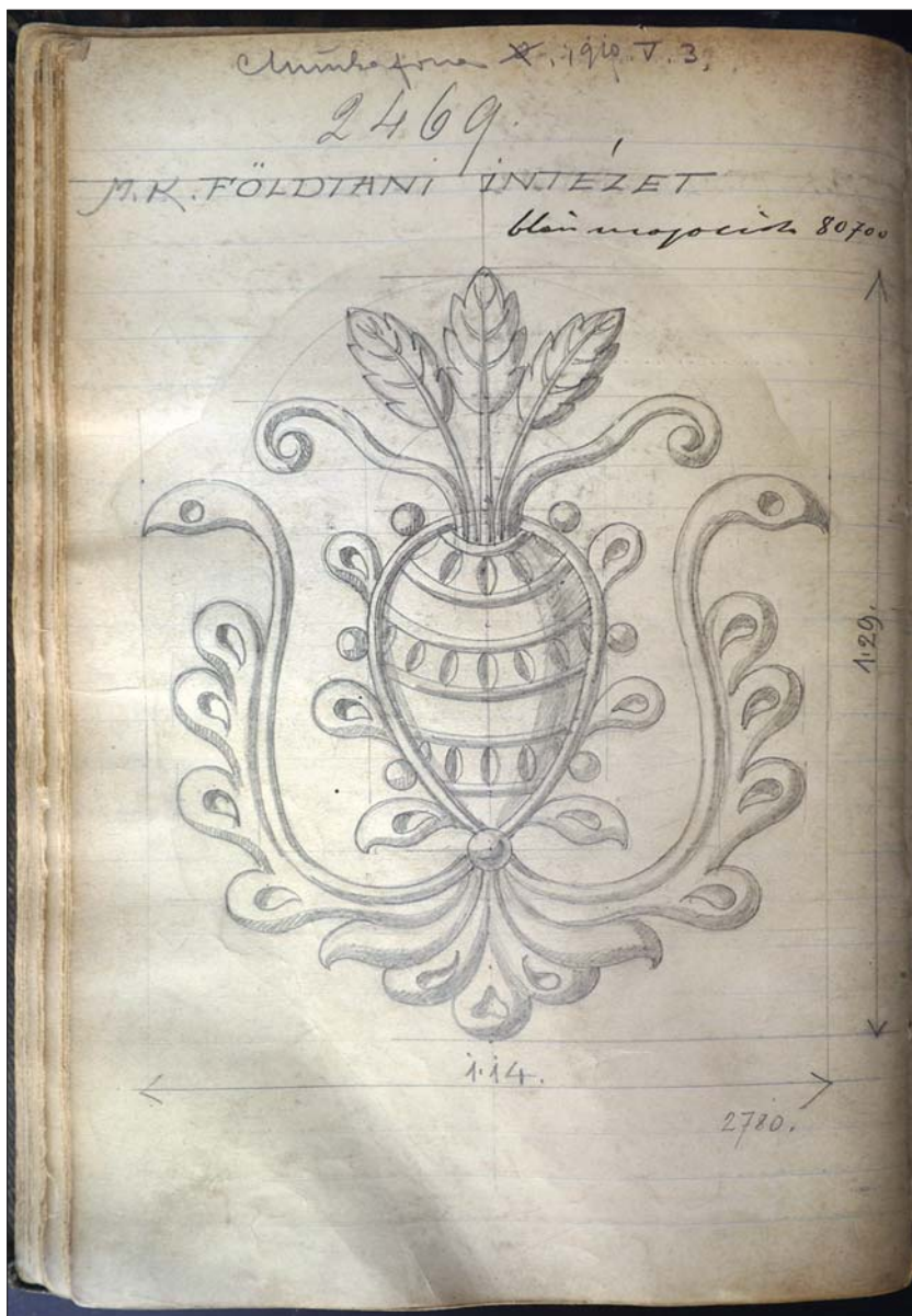
A Zsolnay-gyár 3. számú terrakotta-könyvének lapja a budapesti Földtani Intézet homlokzati kerámiájának rajzával / Page from the terracotta book No. 3 of the Zsolnay Porcelain Manufacture with drawings of ceramics for the façade of the Hungarian Geological Institute, Budapest
